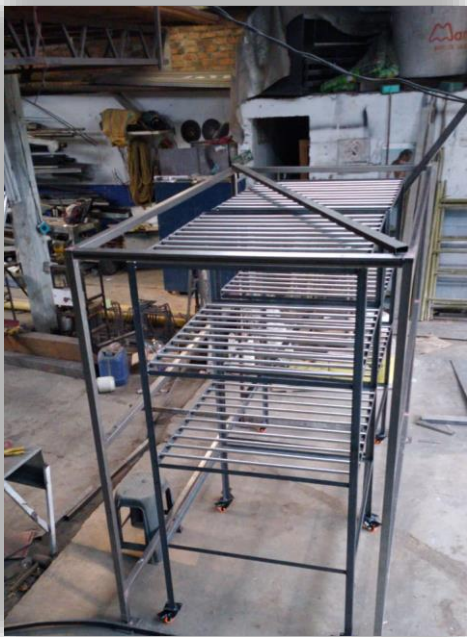
Fotografía 6. Estructura general horno. Perfilamiento.
