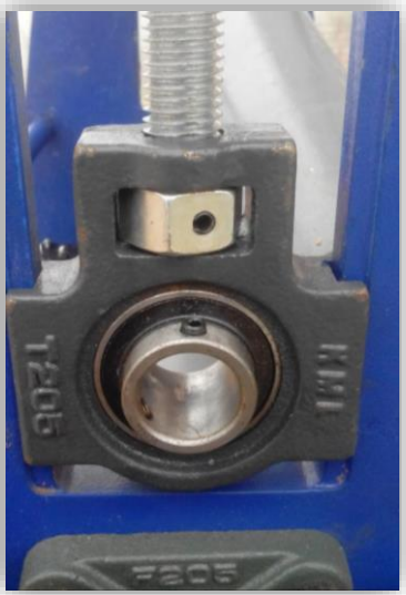
Fotografía 2. Ajuste y alineación de rodillos
