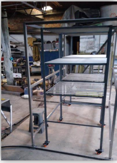
Fotografía 4. Estructura de carros transportadores. Horno
