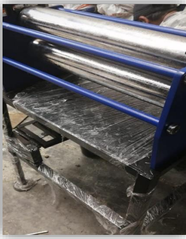
Fotografía 1. Ensamble laminadoras y aplicación de pintura
